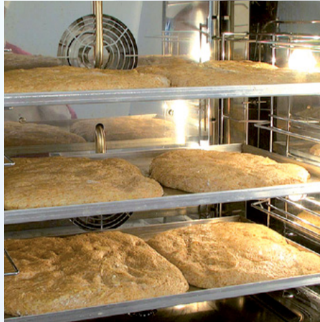
Convección con control de humedad (porcentaje entre 0 and 100%)
