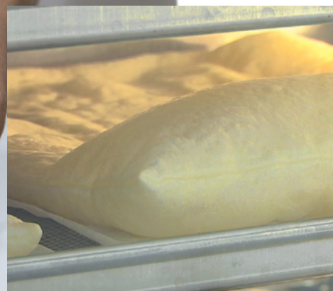
Cocciones con sistema "CLIMA" vapor seco, que de inmediato libera el vapor en la cámara de cocción
